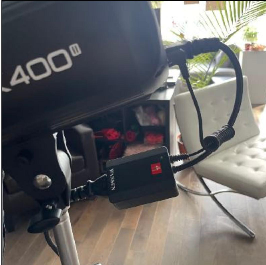
Le gros flash octo a un récepteur branché en permanence à l'arrière dans le fil de courant, qui fonctionne avec le déclencheur.
